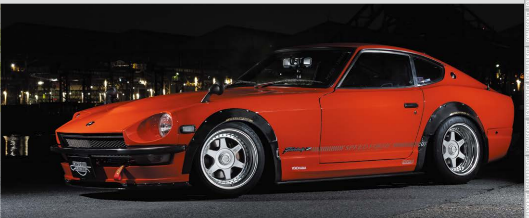
NISSAN FAIRLADY Z (S30) COLOR: CLASSIC SILVER PIERCE BOLT TITAN HEAT P.C.D: 4-114.3 SIZE: F 1680 INSET -28 195/50-16 R 16100 INSET -15 225/45-16 ※ノーマル車両には装着できません。
