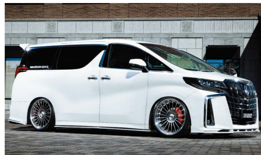
TOYOTA ALPHARD (30) COLOR: TITAN GRADATION NORMAL RIM (RIM OVER DISK) P.C.D.: 5-114.3 PIERCE BOLT: CLASSICAL SIZE: F/R 2195 INSET 36 245/35-21 ※ローダウンが必要です。
