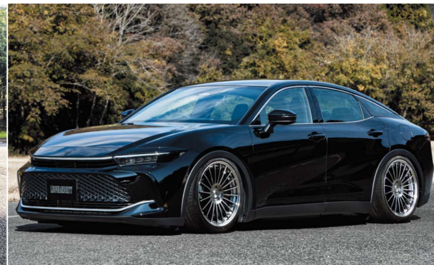
TOYOTA CROWN CROSSOVER COLOR: TITAN GRADATION NORMAL RIM (RIM OVER DISK) P.C.D.: 5-114.3 SIZE: F 2190 INSET 37 245/40-21 R 2190 INSET 42 245/40-21 ※ローダウンが必要です。
