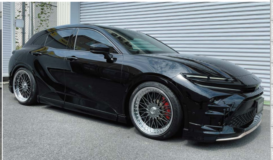
TOYOTA CROWN SPORT COLOR : SBC REVERSE RIM P.C.D : 5-114.3 SIZE : F 21100 INSET 36 245/40-21 R 21100 INSET 33 245/40-21 ※ローダウンが必要です。
