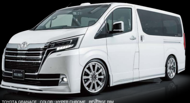
TOYOTA GRANACE COLOR: HYPER CHROME REVERSE RIM P.C.D.: 6-130 PIERCE BOLT: CLASSICAL SIZE: F 2095 INSET 40 245/40-20 R 2095 INSET 39 245/40-20 ※ローダウンが必要。
