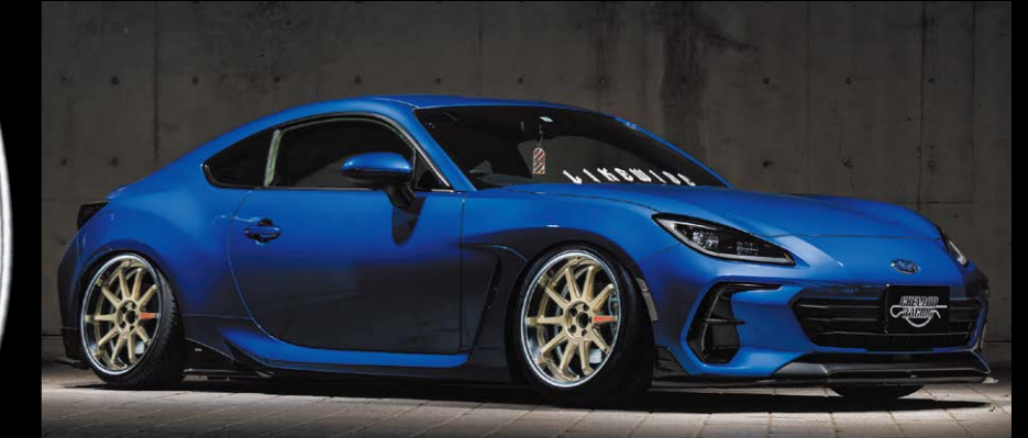
SUBARU BRZ COLOR: PREMIUM GOLD REVERSE RIM P.C.D.: 5-100 SIZE: F/R 1885 INSET 22(SL) 225/40-18 ※ノーマル車両には装着できません。
