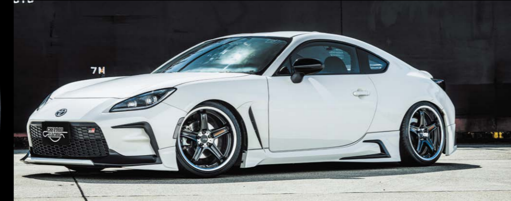
TOYOTA GR86 COLOR: BLACK CENTER POLISH REVERSE RIM P.C.D.: 5-100 SIZE: F/R 1885 INSET 25(SL) 225/35-18 ※ノーマル車両には装着できません。
