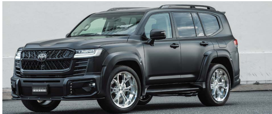
TOYOTA LANDCRUISER 300 COLOR: MACHINING CLEAR REVERSE RIM P.C.D.: 6-139.7 SIZE: F/R 22105 INSET -7 285/45-22 ※オーバーフェンダー(75mm)が必要です。
