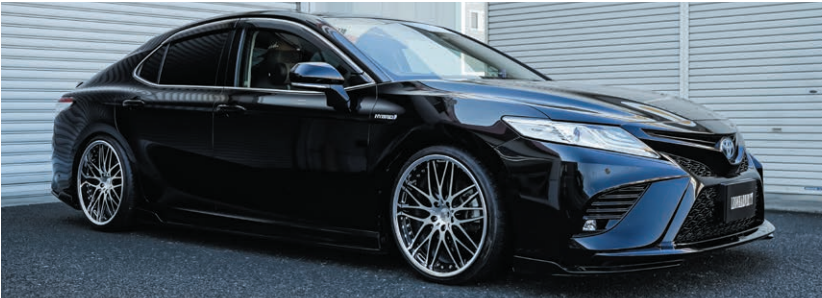
TOYOTA CAMRY (70) COLOR: BLACK/POLISH REVERSE RIM P.C.D: 5-114.3 SIZE: F 2090 INSET 36 (L) 235/30-20 R 2095 INSET 38 (SL) 245/30-20 ※ノーマル車両には装着できません。
