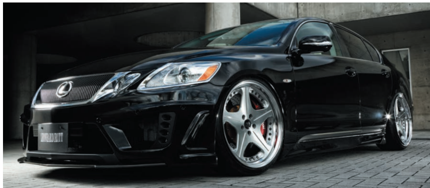
LEXUS GS (190) COLOR : 3D BRUSHED NORMAL RIM PIERCE BOLT : CLASSICAL P.C.D : 5-114.3 SIZE : F 2090 INSET 20 ※10mm SPACER INSERT R 20100 INSET 20 ※15mm SPACER INSERT TIRE : F 225/35-20 R 245/35-20 ※ノーマル車両には装着できません。
